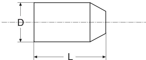
Les diamètres nominaux (DN) indiqués dans les tableaux correspondent au diamètre intérieur du tuyau.
