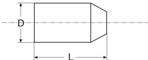
Les diamètres nominaux (DN) indiqués dans tous les tableaux correspondent au diamètre intérieur du tuyau.
